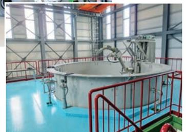
試験フィールドにある円筒型プール（写真上）とタンク内を上下に昇降可能な多関節マニピュレータ（写真下）
